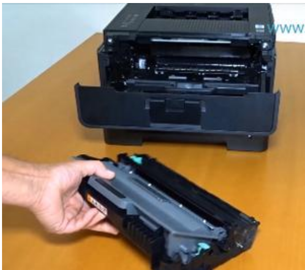
7. Die komplette Trommel-Tonereinheit nun wieder in den Drucker mit etwas Schwung einsetzen
