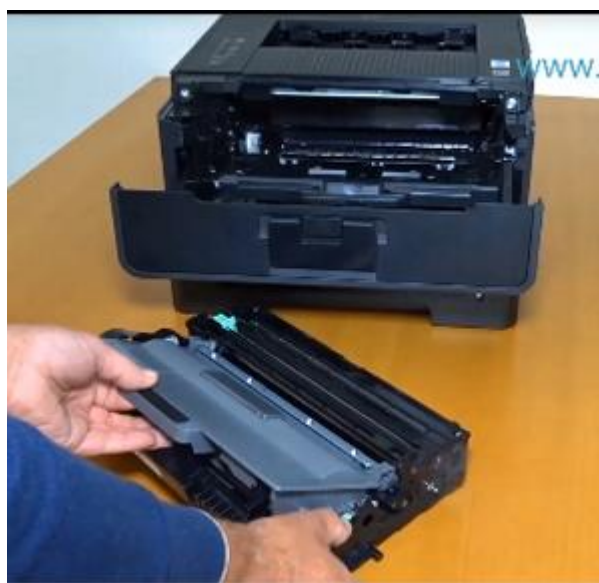
4. Grünen Hebel rechts drücken und Toner aus der Trommeleinheit herausnehmen
