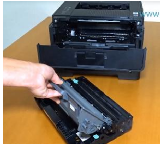
6. Neuen Toner in die Trommeleinheit in umgekehrter Reihenfolge wieder einsetzen bis ein Klicken zu hören ist.
