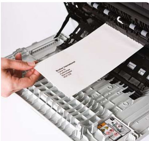
Bedrucken Sie Briefumschläge und dickere Medien mit Hilfe der Multifunktionszufuhr.
